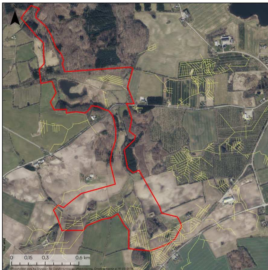
Figur 3-27 Oversigt over registreret dræn (gule markeringer) i undersøgelsesområdet (rød markering). Ortofoto hentet via Styrelsen for Dataforsyning og Infrastruktur, marts 2024.
