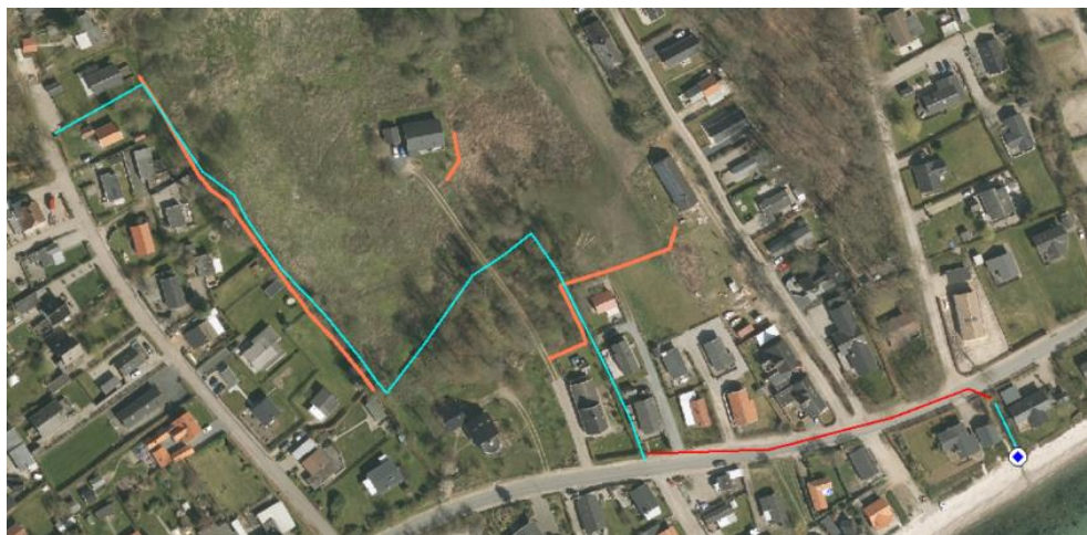
Figur 3-7 Kelstrup Strand vest Forslag B. Man kan tilbageholde vand med diger som vist.
