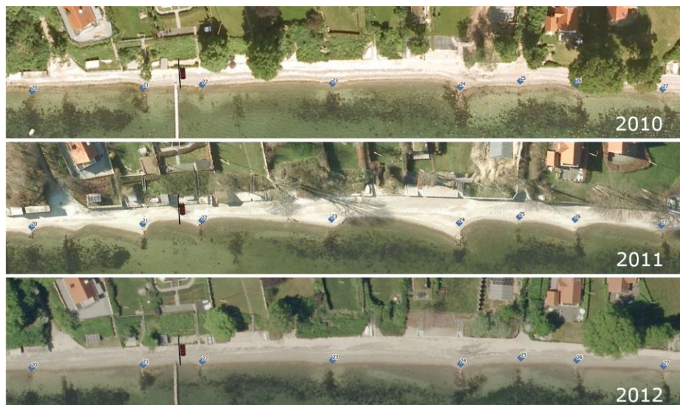
Figur 2-2 Kysten ved St.: 1000 før stormen i 2010 - lige efter stormen i 2011 og året efter stormen i 2012. Bemærk luv-/læside mønstre ved hofde 20 til 27 i 2011 efter stormen og kystens evne til at genfinde den dynamiske ligevægt for "hverdags"-stranden igen i 2012.
