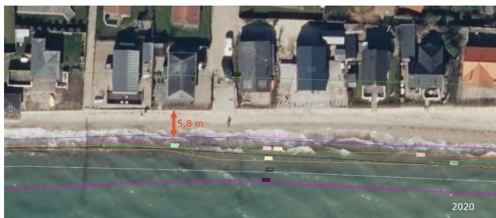
Figur 2-3 Stranden ved Kelstrup Strand er nu så smal, at der ikke skal mange større bølger til, før der sker skade på boliger i 1. række. Bemærk stregerne i de forskellige farver som markerer kystlinjen ved forskellige årstal fra 1954 og frem til i 2020.
