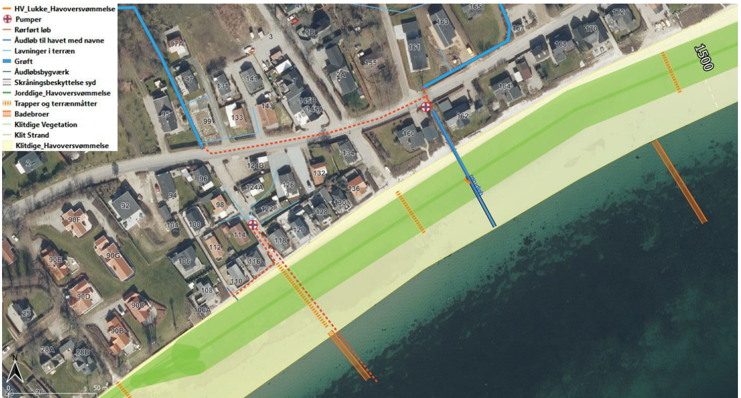
Figur 24 Kelstrupvej og Kelstrup Nørreskov har oversvømmelsestruet bagland, så klitten gøres højere og bredere samtidig med at nedbør håndteres med grøfter, lavninger, rørførte løb, udløbsbygværker med højvandslukke og pumper.
