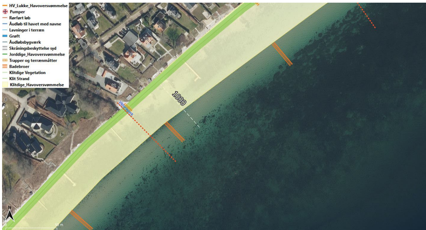
Figur 22 Kelstrup Kystvej-området har sandstrand med klit og badebroer. Det nuværende rørudløb bliver forlænget under sandet og terrænmåtte lagt hen over klitten.
