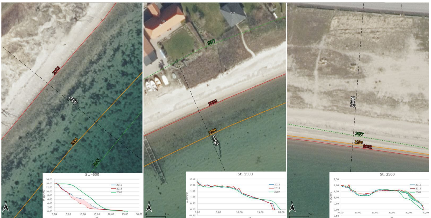
Figur 7 Kystlinjens placering over tid på tre lokaliteter langs Vores Kyst. Ved St.-500 er der naturlig erosion og kystlinjen er derfor længst havværts i 1877, mellem i 1954 og mindst i 2022. Ved St.1500 er kystlinjen rykket meget havværts fra 1877 til 1954 med sandaflejring, hvorefter erosion har ført kystlinjen landværts til 2022. Ved St. 2500 er der langsom kystfremrykning fra 1877 over 1954 til 2022.
