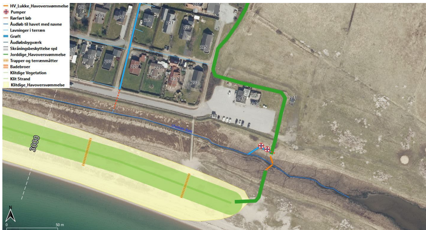
Figur 32 Den østligste del af klitdiget og tværdiget med højvandslukke af Ulvekær Bæk og pumper til situationer med høj ydre vandstand i havet – og derved lukkede højvandslukker.
