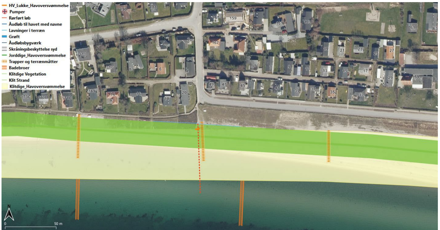
Figur 30 Hejsager Strandvej øst og Hejsager Strandby vest med klitdige og bredere strand til håndtering af havoversvømmelse og akut erosion. For at fange regnvand landværts klitdiget er der udlagt lavninger bag klitdiget og rørført løb under klitdiget med højvandslukke. Der er udlagt terrænmåtter og etableret badebroer.
