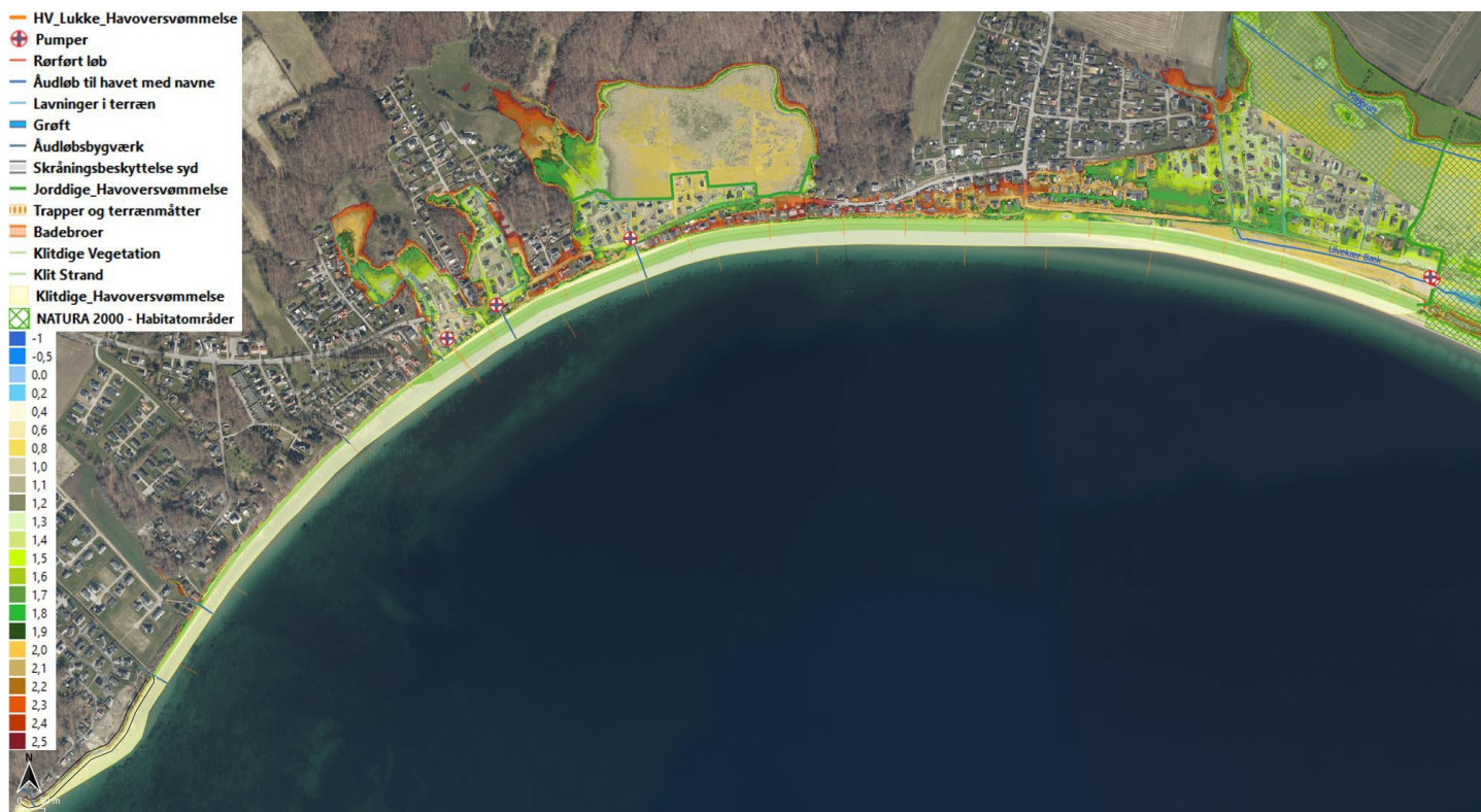
Figur 18 Den samlede løsning med terrænhøjder og habitatafgrænsning. Sandet er gennemgående kystelement med lokal skråningsbeskyttelse i vest ved Blokhusskoven, sandstrand med klitrække til Kelstrupvej og derefter klitdige med vandhåndtering og -parkering i baglandet. Lavninger løber i grøfter og videre via pumper til havet, så hele Vores Kyst er blevet klimarobust og fremtidssikker.
