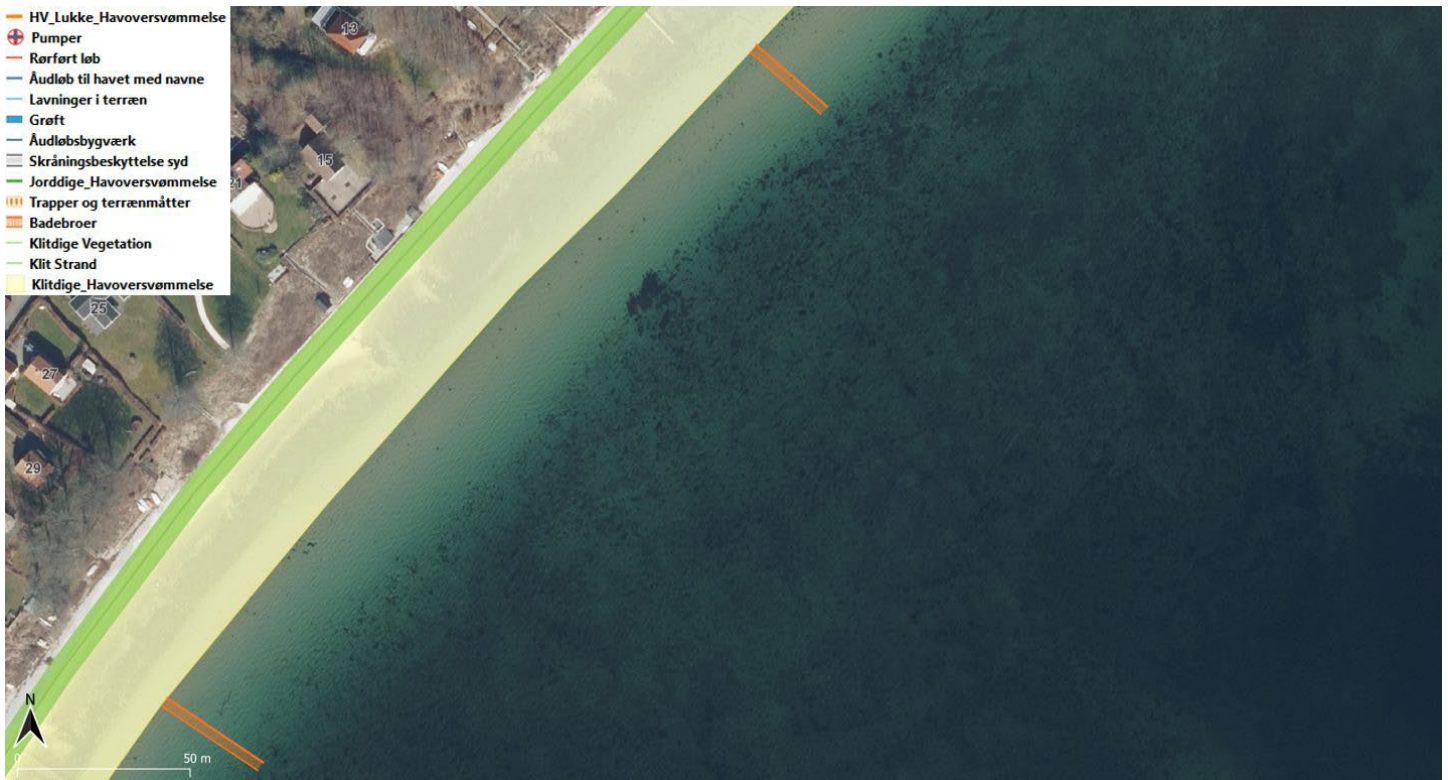
Figur 21 Kelstrup Skovvej bliver erosionsfrigjort med sandstrand og lille klit med vegetation for at holde på sandet, så det ikke blæser op i haverne. Der er tilføjet to badebroer. Boligejerne kan passere klitten ud for deres egen nedgang for at komme til vandet, da der forventes meget lidt slid på vegetationen.
