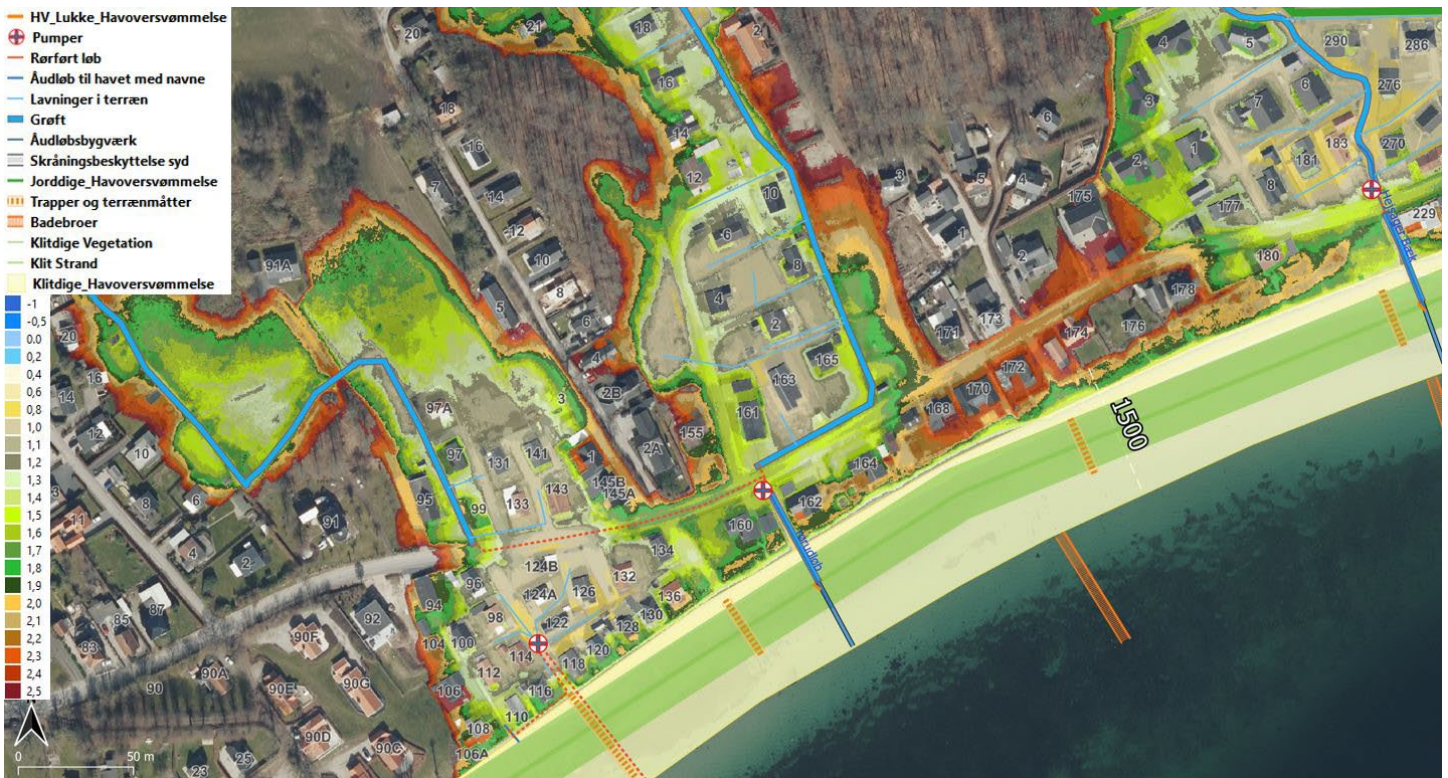
Figur 26 Det lavtliggende bagland er oversvømmelsesfrigjort med kombination af forskellige elementer. Bemærk at Kelstrupvej 94-136-området er lokalt meget lavtliggende og har fået lavninger og egen kuppelrist med pumpe.
