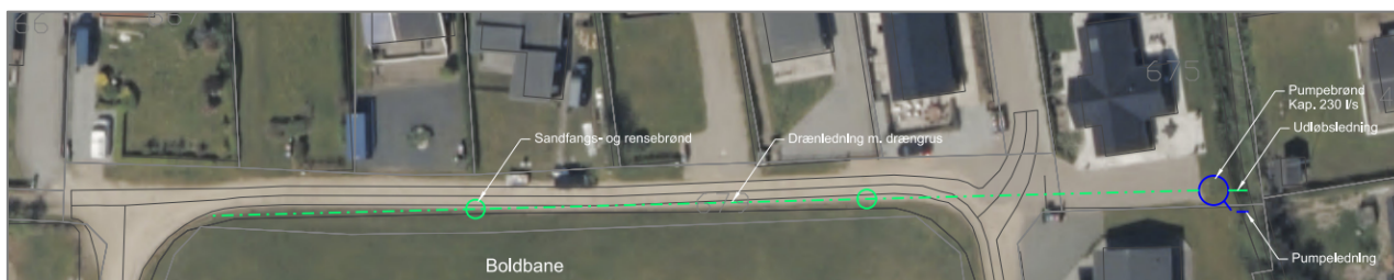
Figur 3-18: Oversigtsplan af afvandingsystem for Fredskovparken – fra tegning VK-D-TH-0211.
