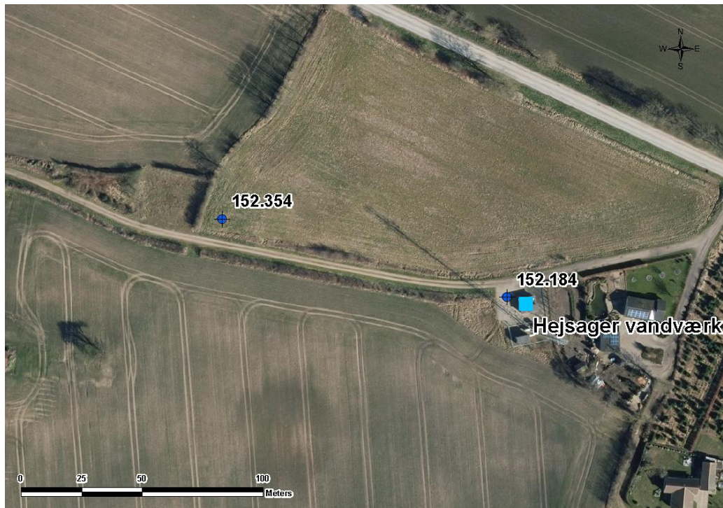
Figur 5-1: Hejsager Vandværk med indvindingsboringer. Boringer angives med DGU-nummer.
