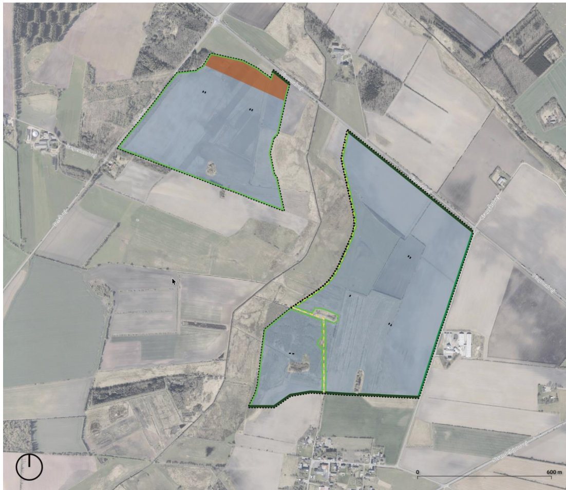
Figur 5.1: Afgrænsning af plan- og projektområdet for solcelleanlægget på 94 ha, vist med sort stiplede linje. Med gråblå flade ses mulige byggefelt til opstilling af solcellepaneler, der udgør 84 hektar. Med orange flade ses byggefeltet til transformere og batterianlæg som udgør 2,7 ha. De resterende 7,3 ha udlægges til gå- og cykelsti (gul stiplede linje), beplantningsbælter, samt bygningsfriezoner mod eksisterende naturområder.
