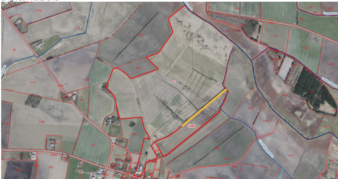
Figur 4: Kommende skelgrøft er vist med orange streg. Sort streg er eksisterende dræn. Blå streg er offentlige vandløb. Rød streg og tal viser matrikelgrænser og -numre. De relevante matrikler er vist med fed streg og tal.
