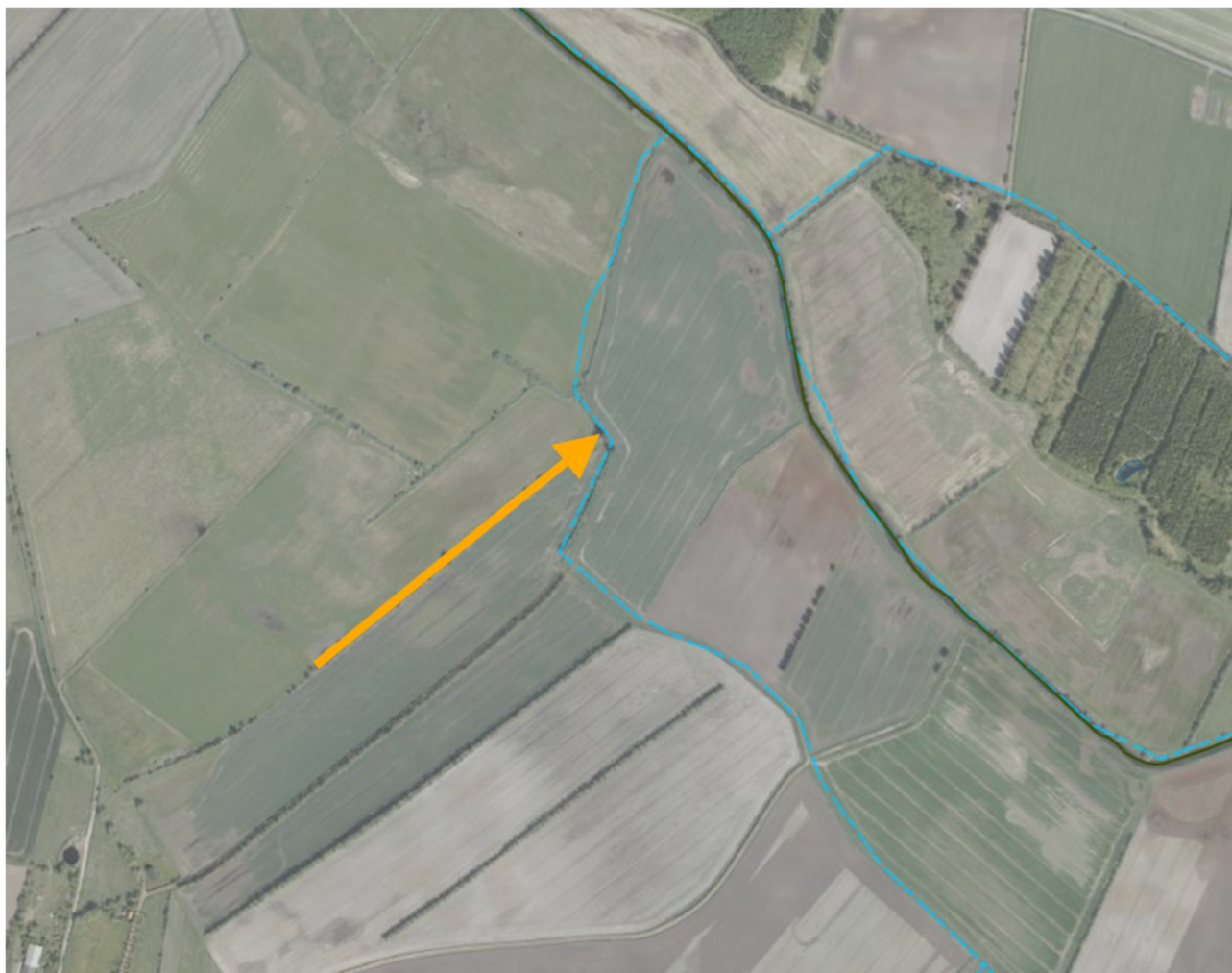
Figur 3. Viser at den ny afvandringsgrøft udløber til det beskyttede vandløb.
